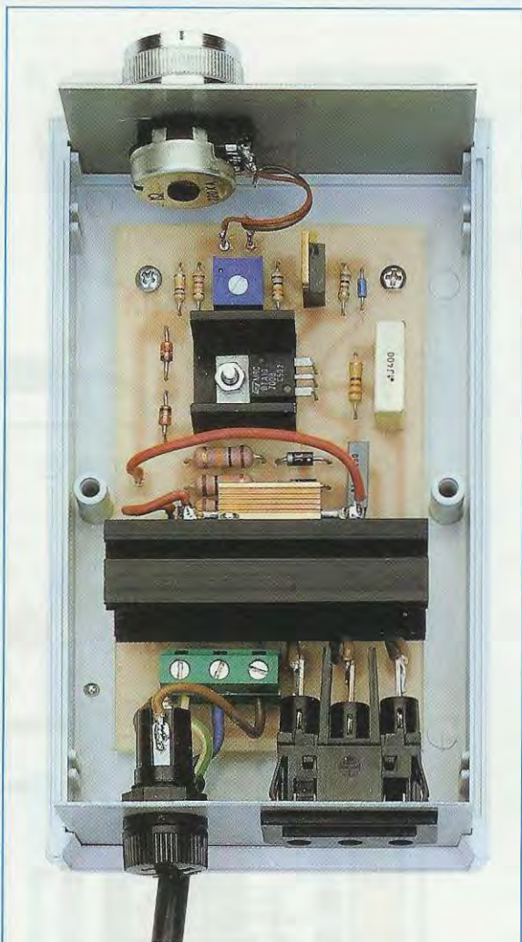
Fig.12 Il circuito stampato LX.1539 va bloccato sul piano del mobile plastico utilizzando 4 viti autofilettanti.
