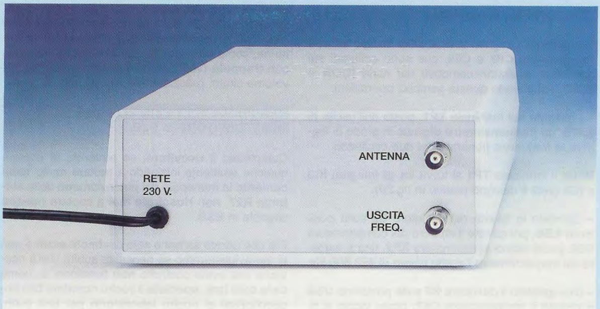
Fig.28 Sul pannello posteriore del mobile fissate due prese femmina BNC (vedi fig.20). Quella superiore serve per entrare con il segnale captato dall'antenna, mentre quella inferiore serve per prelevare il segnale da applicare ad un frequenzimetro digitale (come il Kit LX.1525), per conoscere la frequenza sulla quale si è sintonizzati.
