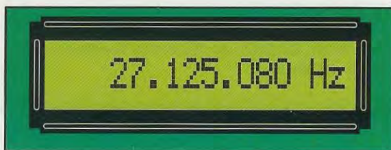
Fig.3 Se sull'ingresso B , che non utilizza nessun Prescaler, applichiamo una frequenza di 27.125.085 Hz questa verrà divisa x10 dalla nostra base di tempi di 0,1 secondi, quindi l'ultima cifra di destra verrà sostituita da uno 0. Vedremo perciò apparire il numero 27.125.080.
