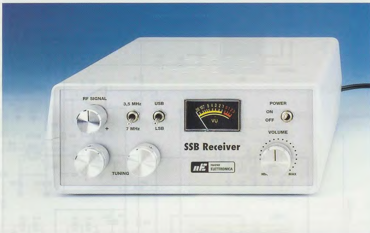
Fig.11 Come si presenta il pannello frontale del ricevitore SSB per i 3,5 e i 7,0 MHz. Per la sintonia (vedi Tuning) abbiamo utilizzato due potenziometri: uno per la sintonia normale ed uno per la sintonia fine (vedi fig.20). Il potenziometro R1, indicato dalla scritta RF Signal, serve per attenuare i segnali che giungono molto forti.
