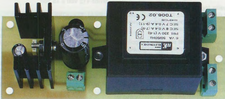
Fig.17 Qui sotto la foto dello stadio di alimentazione che vi fornirà la richiesta tensione stabilizzata di 12 volt. Per evitare errori, ricordatevi che la tensione Positiva esce dal foro di sinistra della morsettiere. Questo stadio va bloccato sul piano del mobile plastico (vedi fig.19) utilizzando 5 distanziatori plastici provvisti di base autoadesiva.
