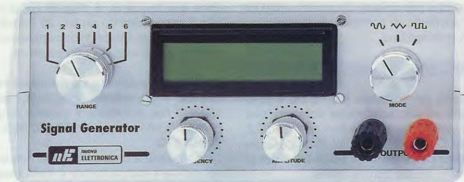
Fig.21 Il commutatore per il cambio gamma è posto sulla sinistra, mentre il commutatore per il cambio delle forme d'onda è posto a destra. In basso a sinistra è applicato il potenziometro per variare la frequenza e a destra quello per variare l'ampiezza.
