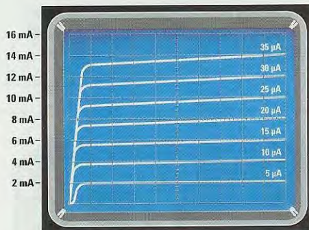
Fig.44 Se avete ruotato il commutatore VOLTS/DIV. del CH2 per una sensibilità media, ad esempio a 0,2 volt, sullo schermo vedrete 7 tracce complete e uniformemente ben distribuite.
