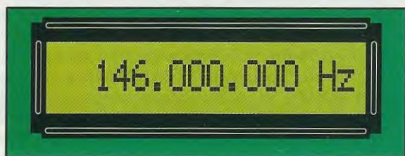
Fig.2 Se sull'ingresso A applichiamo una frequenza di 146.000.048 Hz, questa verrà subito divisa x10 dal Prescaler, poi divisa x10 dalla base di tempi di 0,1 secondi, quindi sul display le due cifre di destra rimarranno fisse sullo 00 e apparirà il numero 146.000.000.
