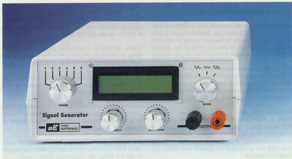
Fig.1 Foto del mobile del Generatore BF in grado di fornire le 3 più comuni forme d'onda, Sinusoidali, Triangolari e Quadre. NOTA: per ottenere delle frequenze stabili, il Generatore va acceso 15 minuti prima dell'uso per permettere all'integrato IC1 di stabilizzarsi.
