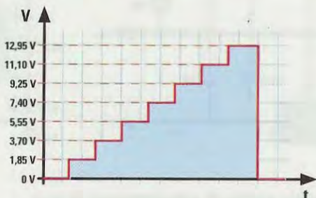
Fig.7 Per testare i transistor PNP ci occorre una rampa a 7 gradini Positiva, che preleviamo dall'uscita di IC3/A (vedi fig.9).
